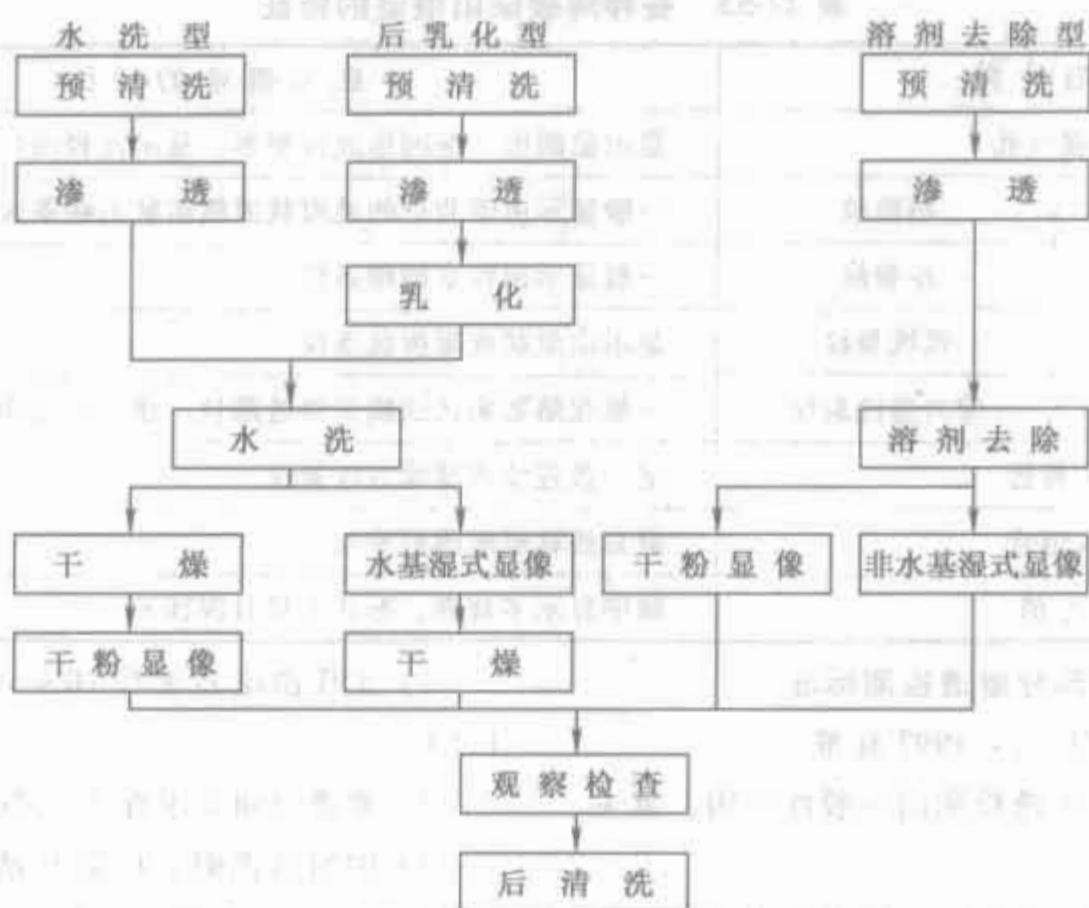
图 27-54 渗透检测的操作程序 [6]
