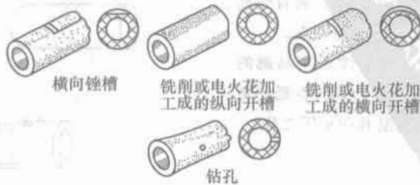
图 27-60 对比试样上人工缺陷的种类和形状 [14]
