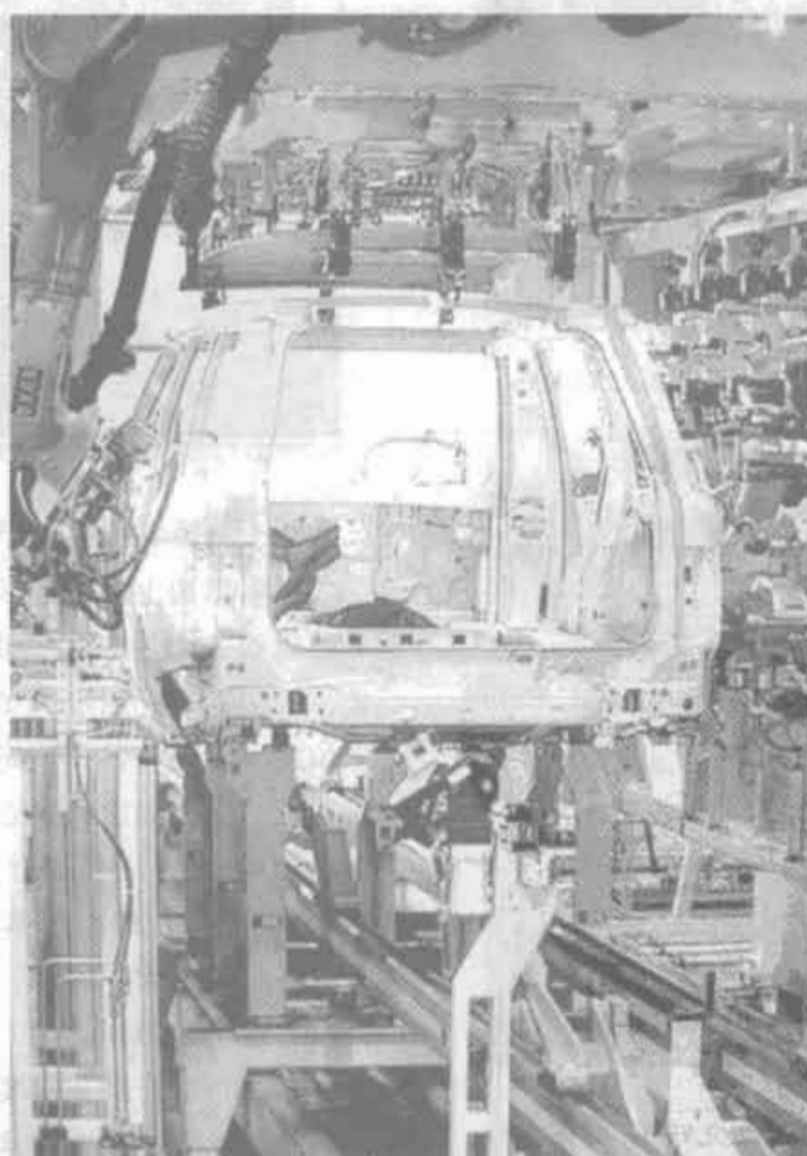
图 26-43 框架式焊装夹具对顶板的装配
