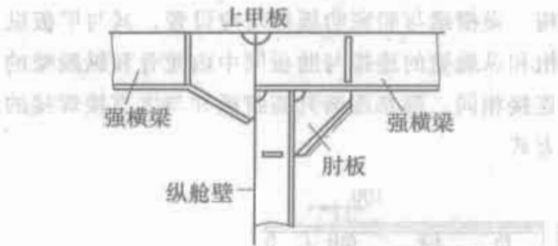
图 16-37 小型油船的甲板纵桁与横舱壁的连接
