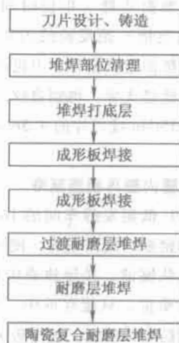
图 32-17 绞刀片刀齿再制造工艺流程
