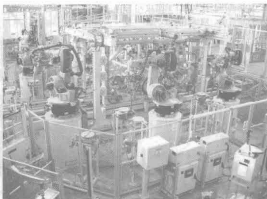
图 26-42 使用框架式焊装夹具的白车身总成合拼装定位焊工位
