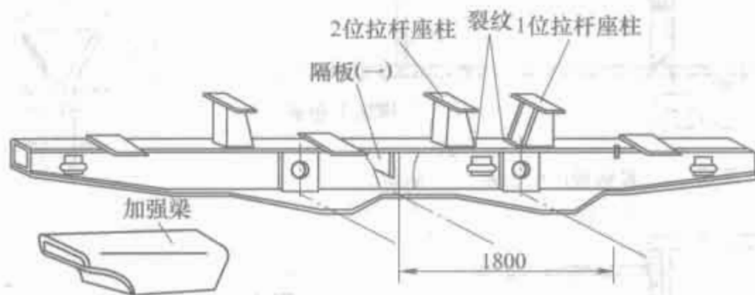
图15-32 侧梁裂纹部位与加强梁
