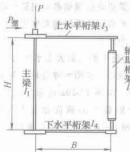
图 17-18 空腹桁架复合主梁截面
