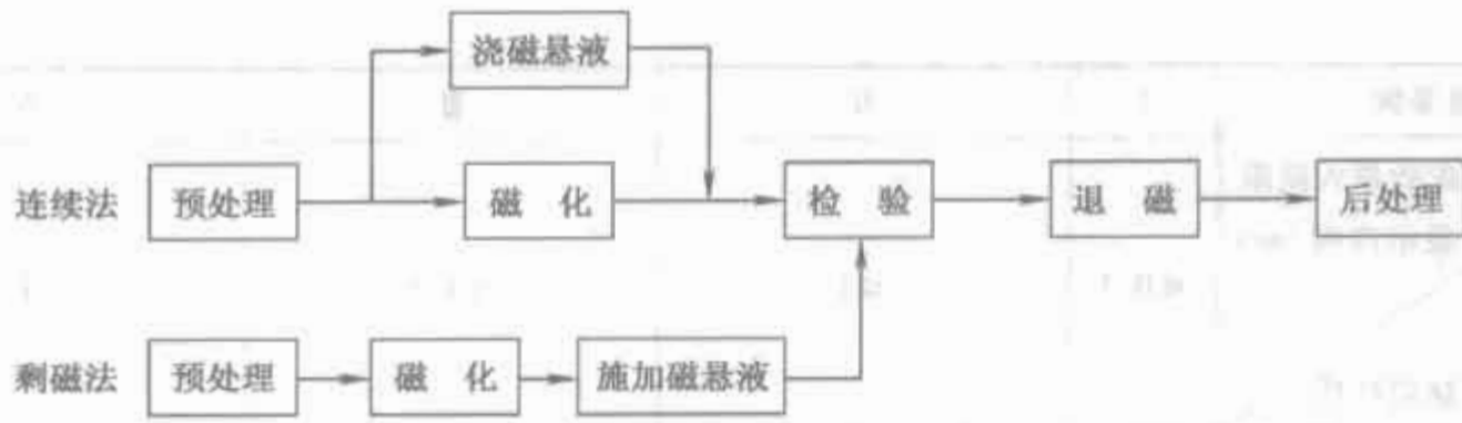
图 27-46 磁粉检测的一般操作程序
