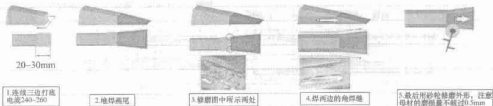
图 20-36 燕尾焊缝焊接顺序与要点
