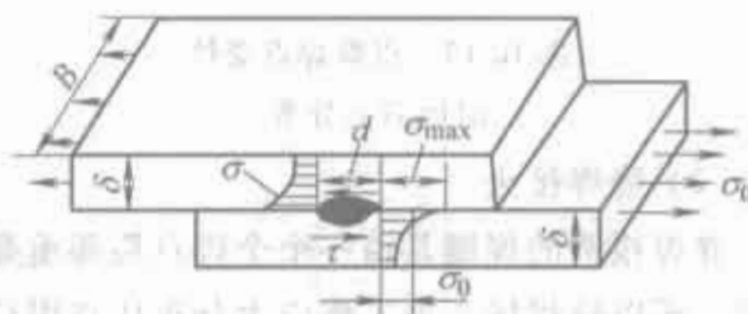
图 10-12 点焊接头沿板厚的应力分布
