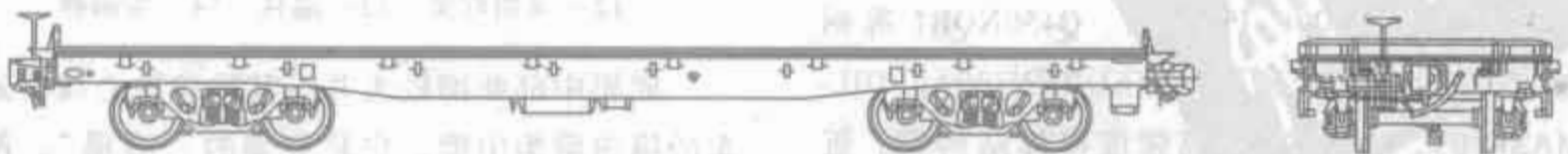
图 15-2 N17A 平车总图
