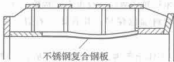
图 18-26 用复合钢板的新结构转轮室
