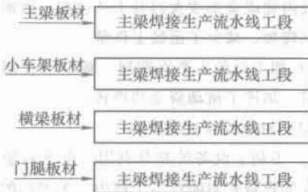
图 29-17 起重机钢结构采用工艺专业化工段示意图
