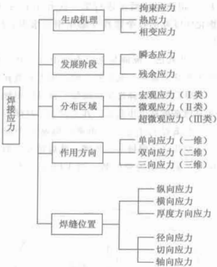
图 4-14 焊接应力分类 [6]
