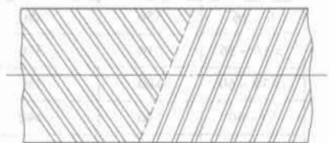
图13-14 扁平绕带多层容器的钢带缠绕方向
