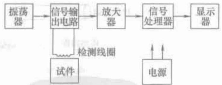
图 27-56 涡流检测系统工作原理图 [14]
